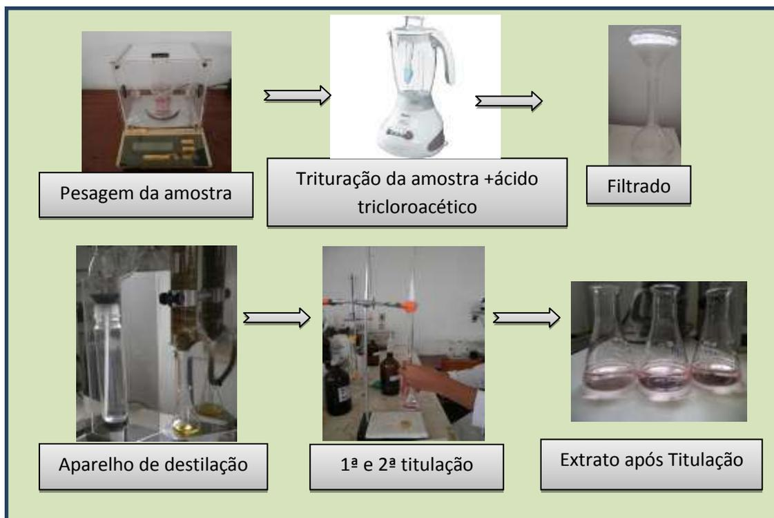
Figura 4. Esquema da determinação das Bases Voláteis Totais e Trimetilamina
