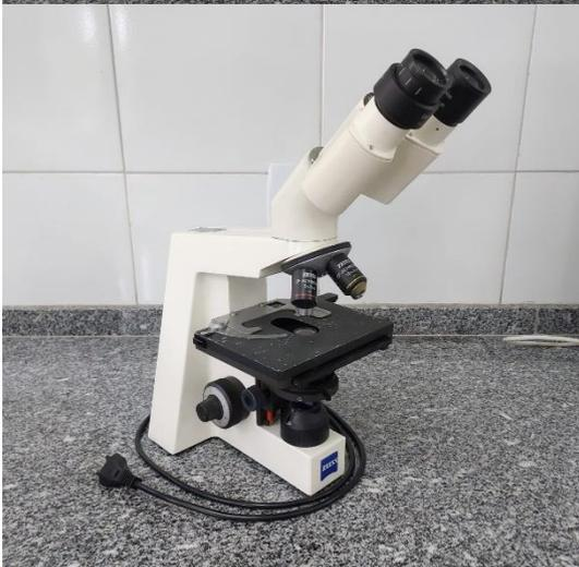
O Microscópio Óptico permite a observação de bactérias, ampliando sua imagem em até 1000 vezes.
