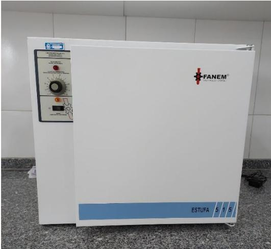
A estufa de secagem é utilizada para secagem de substâncias sólidas, evaporação lenta de líquidos, armazenagem de substâncias líquidas com temperaturas baixas, secagem de vidrarias, etc.
