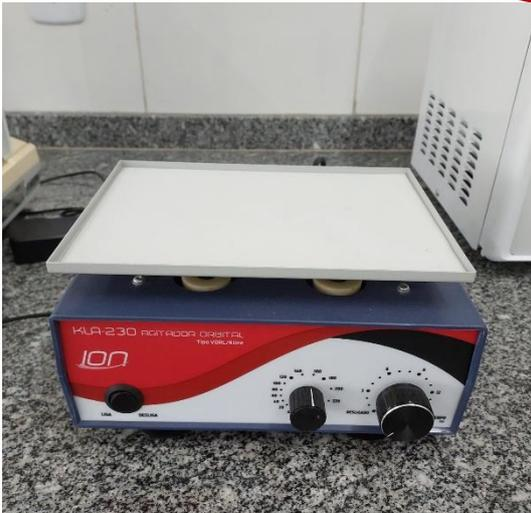
O agitador orbital é um equipamento utilizado no laboratório para misturar, homogeneizar e / ou preparar combinações de substâncias.
